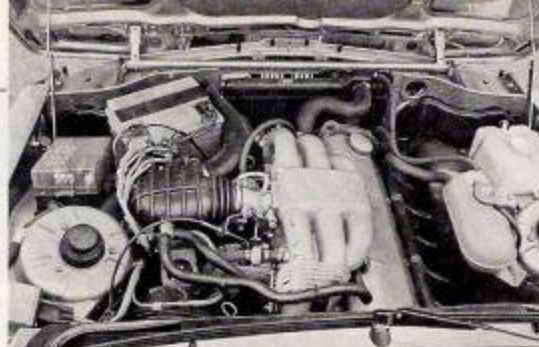
Oben: Deutlich erkennbar die Einspritz-Anlage des Serien-323i
