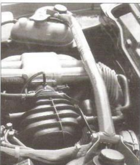
La barre antirapprochement n'est pas d'origine, mais elle renforce encore la précision d'un train avant véritablement diabolique.
