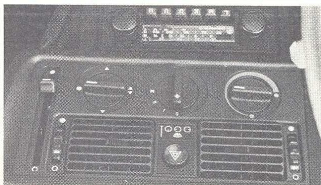
Le chauffage se règle avec précision. On peut simultanément amener de l'air frais soit aux ouïes latérales, soit aux ouïes centrales, soit aux ouïes qui sont situées sur le dessus du tableau de bord.
