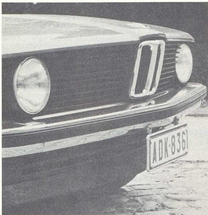
La 318i se distingue des modèles 6 cylindres par sa calandre à 2 phases seulement, mais à iode H4.
