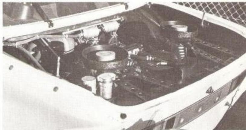
Réservoirs et pompes diverses dans le coffre.
