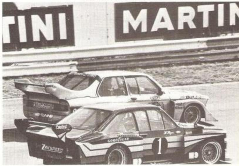
prolonge sur les ailes avant. A l'arrière, le pontet à l'extrémité du toit canalise les filets d'air vers l'immense aileron dont les latitudes de réglage sont variées : incidence, volet articulé, bord de fuite.
