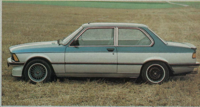
Rechts und unten: Zu den besonderen Gags des Wittmann-BMWs gehört die Lackierung. Die obere Hälfte des Autos wird in der Farbgebung nach vorn hin heller. Diesen Effekt erreichte Wittmann durch Silberbelmischung
