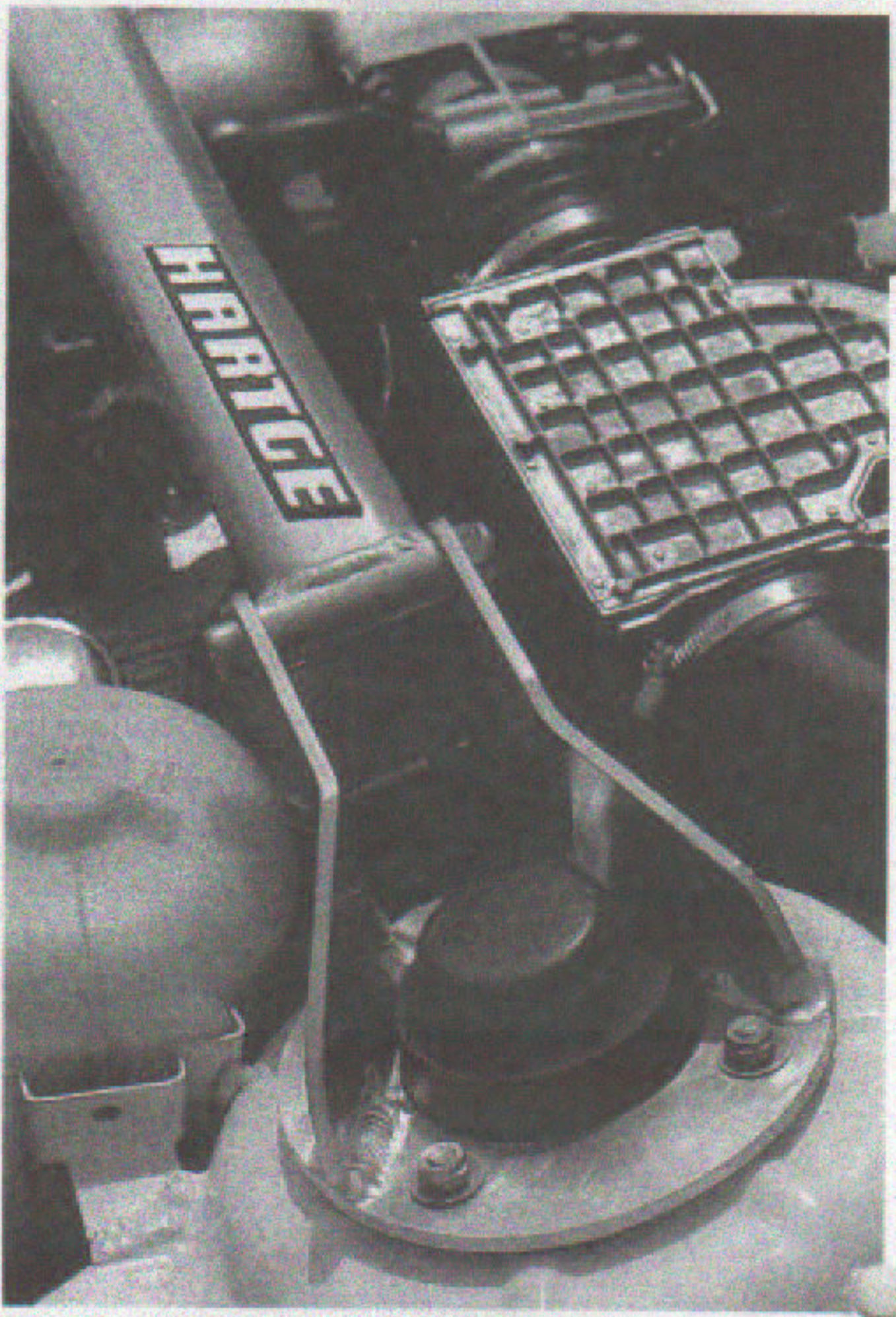
Federbeinbrücke, stabilisiert den Vorderbau, besonders empfehlenswert für Reifen der Serie 50, 60 und TXR-Reifen
