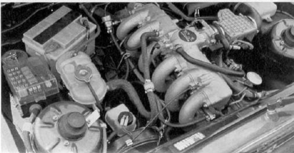
Le moteur de la BMW Alpina B6 est le six cylindres de la 528 i dont la puissance a été portée à 200 ch au lieu de 177.
